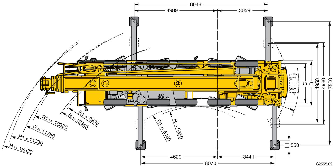
R, = Allradlenkung · All-wheel steering · Direction toutes roues · Tutti gli assi sterzanti · Dirección en todos los ejes · Поворот всеми колесами
